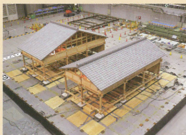
伝統工法木造住宅震動台実験 (E-ディフェンス)
