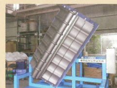
棟回転加力試験風景
